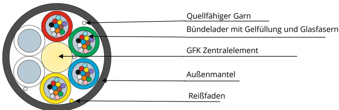
Dieses Kabel besteht aus einem verseilten Kern mit Zentralelement aus Faser-Kunststoff-Verbund (GFK). Um den Kern herum sind die Bündeladern mit in Gel gebetteten Glasfasern sowie - wenn nötig - Blindelemente aus PBT (naturfarben) angeordnet. Der verseilte Kern wird durch quellfähige Garne in seiner Position fixiert. Der Außenmantel besteht aus PA12 Material und ist schwarz. Für leichte Zugänglichkeit zu den Fasern befindet sich ein Reißfaden direkt unter dem Mantel.
