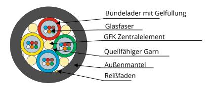
Dieses Kabel besteht aus einem verseilten Kern mit Zentralelement aus Faser-Kunststoff-Verbund (GFK). Um den Kern herum sind die Bündeladern mit in Gel gebetteten Glasfasern angeordnet. Der verseilte Kern wird durch quellfähige Garne in seiner Position fixiert. Der Außenmantel besteht aus PA12 Material und ist schwarz. Für leichte Zugänglichkeit zu den Fasern befindet sich ein Reißfaden direkt unter dem Mantel.
