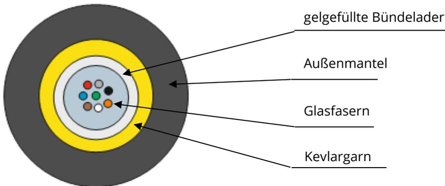
Dieses Kabel besteht aus einer zentralen Bündelader (naturfarben) mit in wasserabweisendem Gel gebetteten Glasfasern. Über der Bündelader liegen dielektrische Festigkeitsgarne. Der Außenmantel besteht aus PE und ist schwarz.
