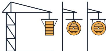
✗ Beim Heben mit Kran niemals direkt anheben, Stahlstange benutzen!
